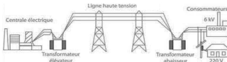
Puissance électrique produite par la centrale et transportée vers les consommateurs :  $P_0 = 600 \text{ MW}$
