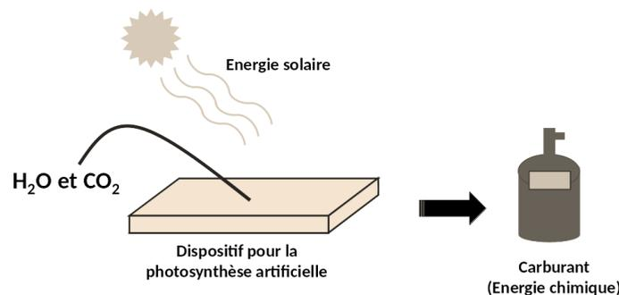
Principe de la photosynthèse artificielle
