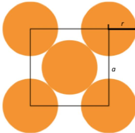
La mesure  $a$  correspond au paramètre de la maille et on suppose que les atomes de silicium sont sphériques et tangents. Le rayon d'un atome de silicium est noté  $r$ .
