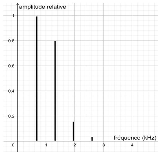
Figure 2. Spectre du mi<sub>4</sub> restitué après passage par un bouchon en mousse
