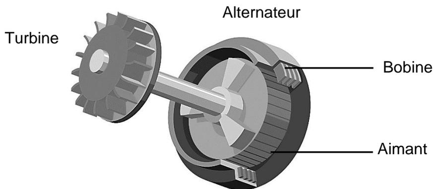
1- À partir du schéma simplifié du couple turbine-alternateur (document 2), indiquer quel élément (aimant ou bobine) constitue la source de champ magnétique et aux bornes de quel élément (aimant ou bobine) peut apparaître une tension électrique.
