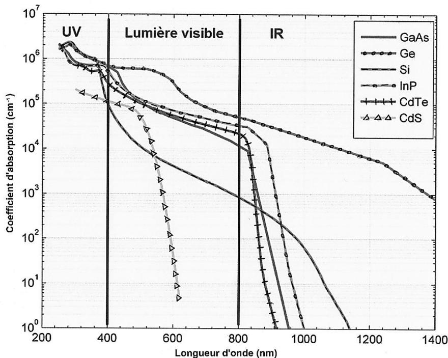
GaAs : arséniure de gallium ; Si : silicium ; InP : phosphure d'indium ; CdTe : tellure de cadmium ; CdS : sulfure de Cadmium.
