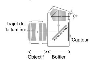
Pour simplifier, l'objectif peut être modélisé par une lentille mince convergente unique, dont la distance focale est égale à celle de l'objectif. Les distances sont donc exprimées par rapport au centre optique de cette lentille.
