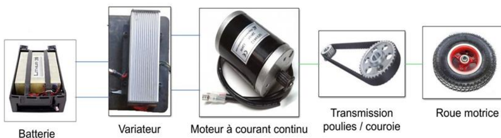
Figure 3 : Chaîne de puissance du skateboard
