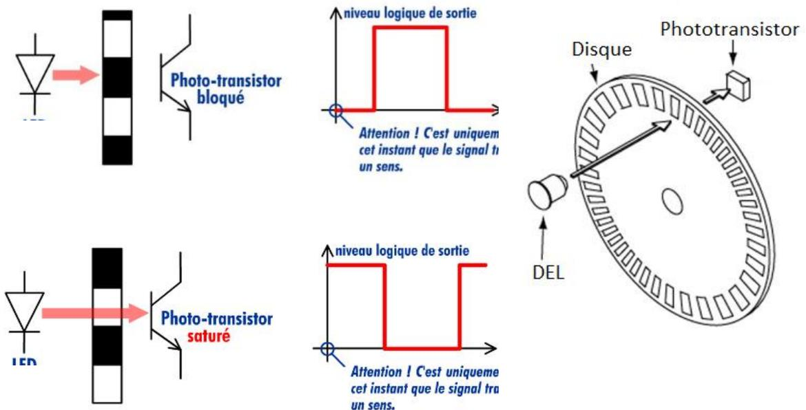
Figure 2-3 : fonctionnement d'un codeur optique incrémental
