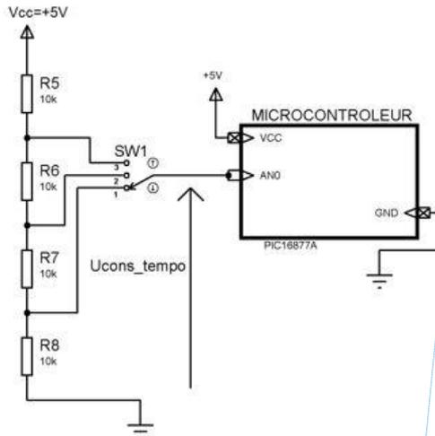
Figure 6 : schéma structurel partiel
