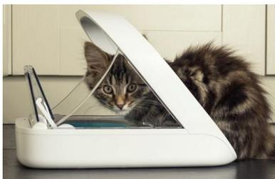
Le distributeur de nourriture pour chat possède une trappe qui ne s'ouvre que lorsque la puce électronique (tag RFID) du chat est scannée et reconnue. Si un animal non enregistré passe à côté du distributeur, le couvercle ne s'ouvre pas ou se referme. Le distributeur Surefeed garantit ainsi que la nourriture est consommée par le « bon animal » domestique. Quand l'animal a mangé et s'éloigne du distributeur, le couvercle se referme automatiquement.
