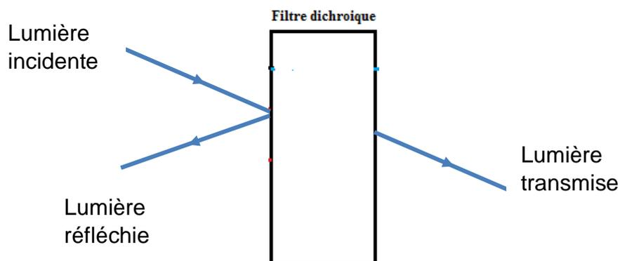
Les filtres colorés standards ne sont pas dichroïques: ils ne séparent pas la lumière en deux faisceaux (réfléchi et transmis) mais absorbent une partie du spectre lumineux.
