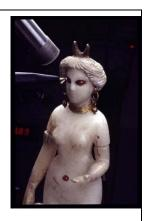
C'est une méthode d'analyse non destructive, sans prélèvement. Cependant, elle ne mesure pas le carbone et l'azote, et elle ne donne pas d'information sur les liaisons chimiques.
