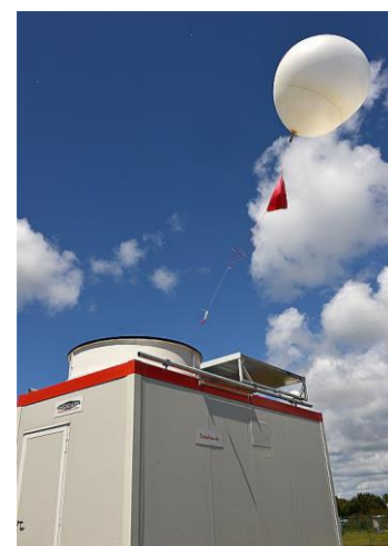
Figure 1 : lâcher de ballon automatique © Météo-France, Pascal Taburet
