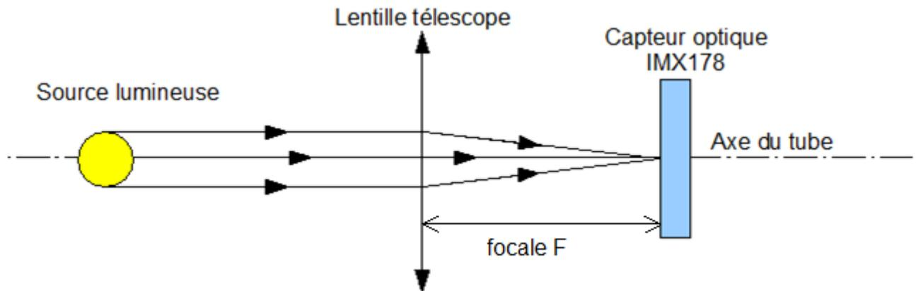
Figure 2 : Pointage correct d'un astre
