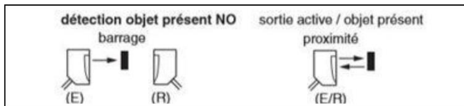
Figure 6 : Capteur infra rouge de type barrage et de type proximité
