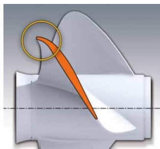
Figure 7 : une hélice est formée de pales s'apparentant à un foil
