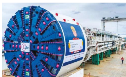
Figure II-1 : Foreuse du tunnelier – Types de tunnel ferroviaire
