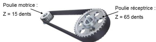
Figure 4 : Caractéristiques du système poulies / courroie
