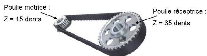
Figure 4 : Caractéristiques du système poulies / courroie
