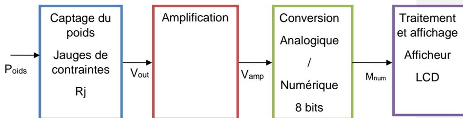
Le poids de la nourriture contenue dans le bol  $P_{\text{oids}}$  évolue entre 0 gr et 258 gr. Ce poids est converti en tension analogique  $V_{\text{out}}$  image du poids comprise entre 0 et 100 mV puis amplifié en une tension analogique  $V_{\text{amp}}$  comprise entre 0 et 5 V. Cette grandeur est ensuite convertie en valeur numérique  $M_{\text{num}}$  sur 8 bits par un convertisseur Analogique Numérique en vue d'être affichée sur un afficheur à cristaux liquides.
