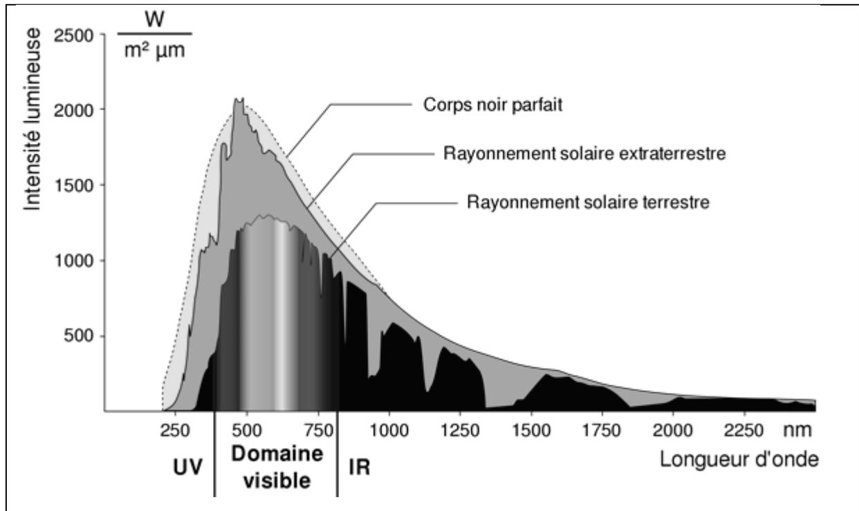
La loi de Wien caractérise le lien entre la température de surface d'un corps noir et la longueur d'onde d'émission maximale de ce corps par la relation :
