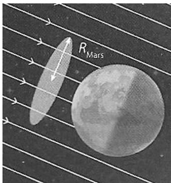
La puissance solaire reçue par Mars traverse un disque fictif de rayon  $R_{Mars}$  et se répartit ensuite sur toute la surface de la sphère martienne de rayon  $R_{Mars}$ . Celle-ci est en rotation sur elle-même.
