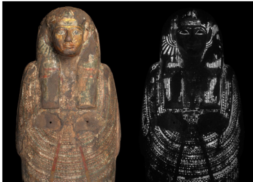
Fig. 2. Photographie visible (gauche) et photographie de la fluorescence sous lumière visible dans l'infrarouge (LIR) servant à repérer le pigment Bleu égyptien (en blanc). Cercueil de femme anonyme, musée du Louvre. Image C2RMF/Anne Maigret. D'après http://technologies.c2rmf.fr
