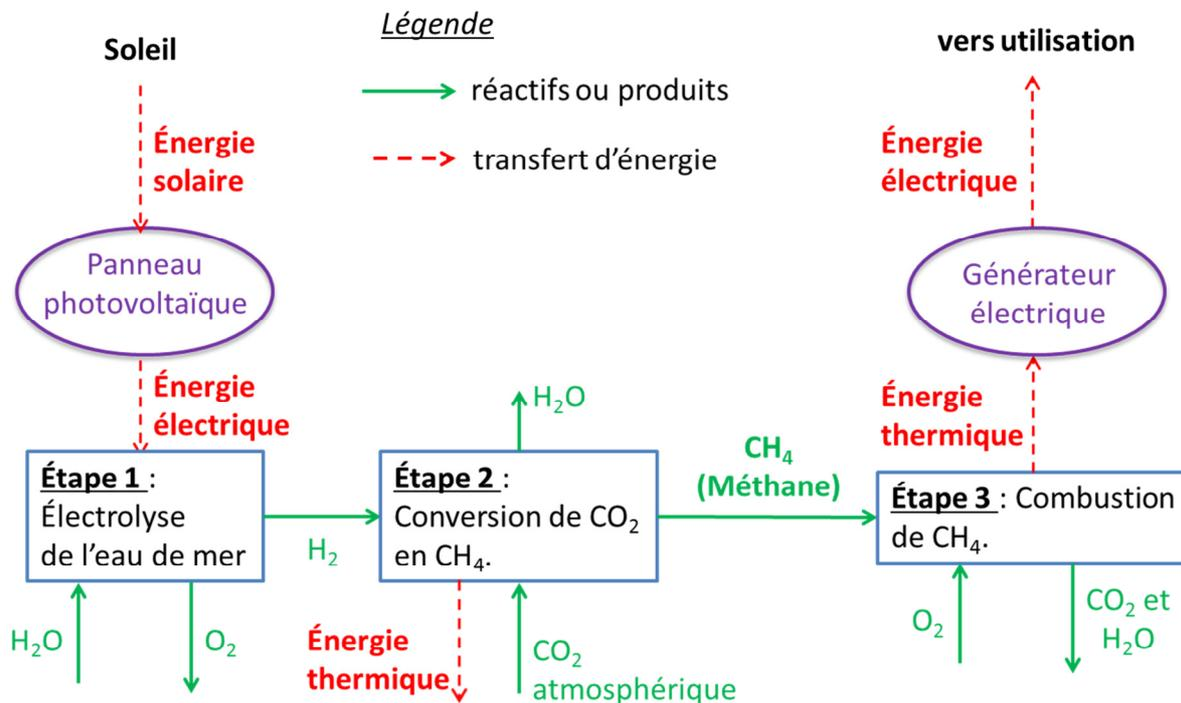
Il se produit dans les différentes étapes les transformations chimiques modélisées par les réactions chimiques d'équation :
