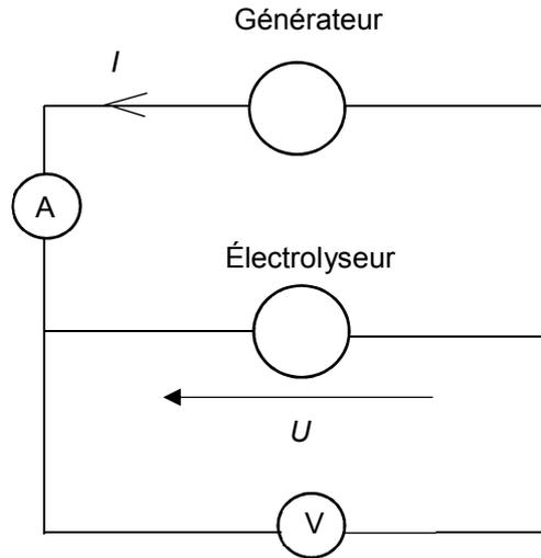
En faisant varier la tension  $U$  aux bornes de l'électrolyseur, on mesure pour chaque valeur de la tension  $U$ , l'intensité du courant  $I$  dans le circuit de l'électrolyseur. On obtient le tableau de résultats suivant :
