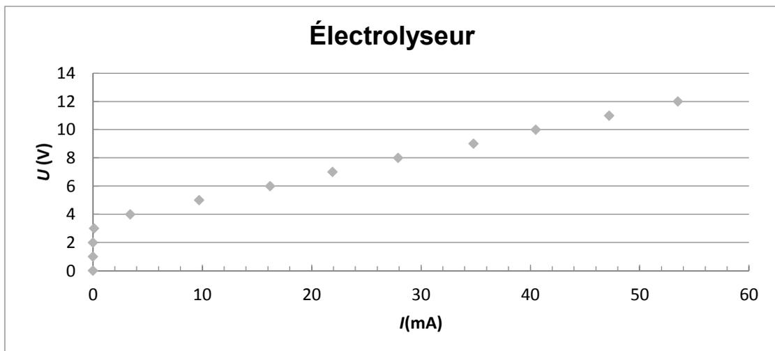
Équation de la droite déterminée à l'aide d'un logiciel de calcul :  $U = 3,46 + 160 \times I$  où  $U$  exprimée en V et  $I$  en A.
