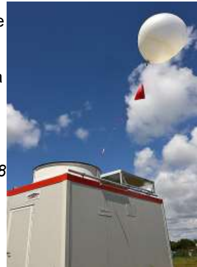
Figure 1 : lâcher de ballon automatique © Météo-France, Pascal Taburet
