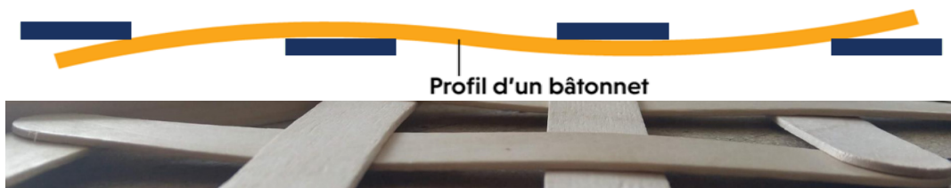
Figure 3 : Schéma de profil d'un bâtonnet déformé dans le croisillon et photo correspondante
