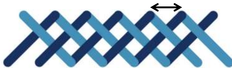
Figure 2 : Croisillon vu de dessus : le croisillon est caractérisé par le pas noté p , distance entre deux sommets consécutifs sur un des bords du croisillon
