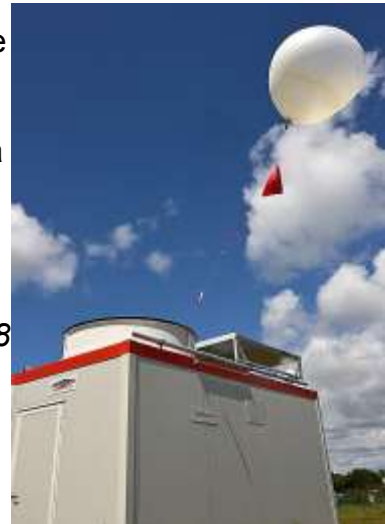
Figure 1 : lâcher de ballon automatique © Météo-France, Pascal Taburet
