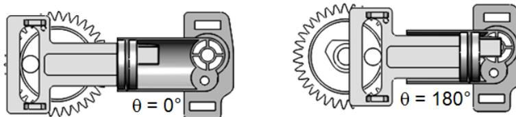
figure 3 : déplacement du piston durant la phase de refoulement
