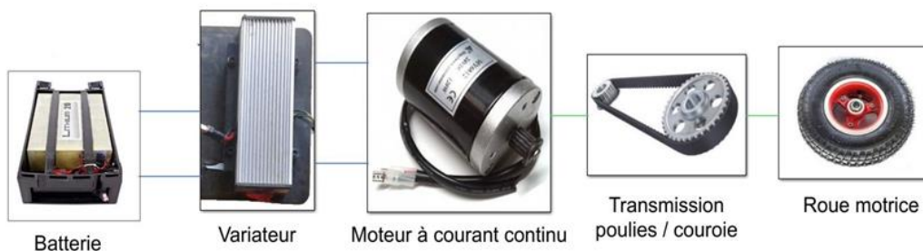
Figure 3 : Chaîne de puissance du skateboard
