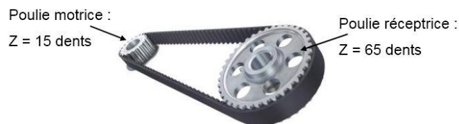
Figure 4 : Caractéristiques du système poulies / courroie
