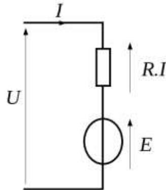
Figure 7 : modèle équivalent du moteur
