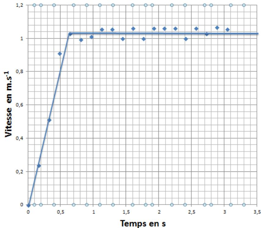
**Q1.1.** A partir du relevé, identifier les deux phases du mouvement en définissant les intervalles de temps de chaque phase. Puis caractériser pour chacune des phases le type de mouvement de la voiture.
