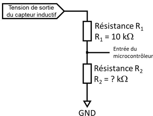
En sortie d'un capteur inductif, il est nécessaire d'adapter la tension délivrée pour être conforme aux caractéristiques des entrées numériques du microcontrôleur. La structure figure 9 permet d'adapter (diviser) la tension issue du capteur en une tension comprise entre 0 V et 5 V. Le courant dévié sur l'entrée du microcontrôleur est considéré comme nul.
