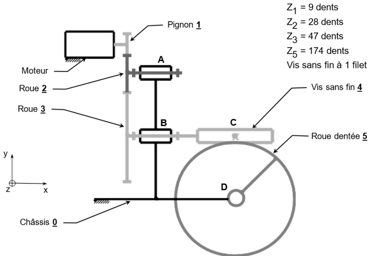
Question I.2 **Identifier** la liaison entre la roue 2 et le châssis 0 : nom, point et axe de la liaison. **Identifier** de la même manière la liaison entre la roue dentée 5 et le châssis 0.
