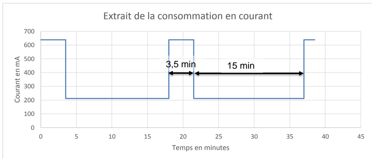
Question II.5 À partir des mesures réalisées **calculer** le courant moyen consommé par la monture et **justifier** le choix de la batterie.
